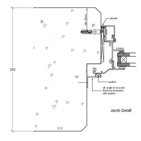
TYPICAL DOUBLE-GLAZED WINDOW INSTALLATION DETAIL - SILL, HEAD AND JAMB
